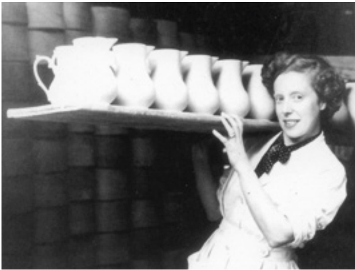
Jahrzehnte lang war das Tragen des Porzellans auf sogenannten Planken die einzige Möglichkeit, es von einem Arbeitsplatz zum nächsten zu transportieren. Selbst Frauen mussten große Gewichte geschickt balancieren.
