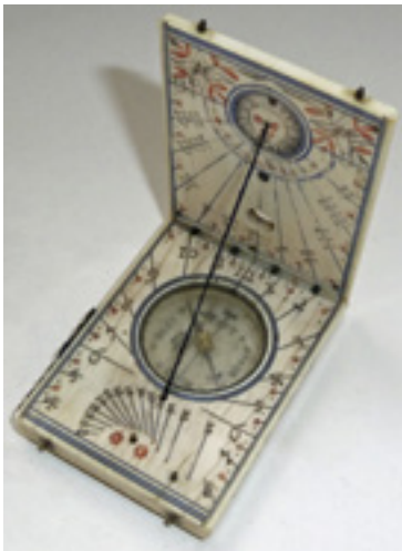
Die Fotos zeigen oben links eine Klappsonnenuhr mit Monduhr und Kompass (1616), daneben eine Holzräder-Turmuhre der Arzberger Kirche (1666) und unten eine würfelförmige Sonnenuhr um 1800.
